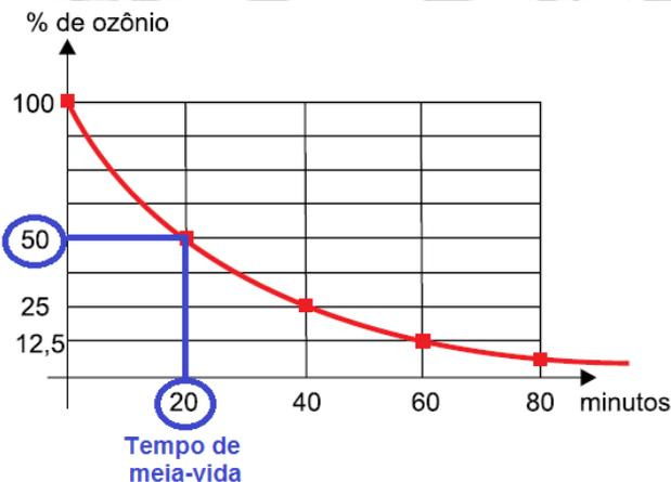
$$100 \% \xrightarrow{t_{(1/2)}} 50 \% \xrightarrow{t_{(1/2)}} 25 \% \xrightarrow{t_{(1/2)}} 12,5 \% \xrightarrow{t_{(1/2)}} 6,25 \%$$
