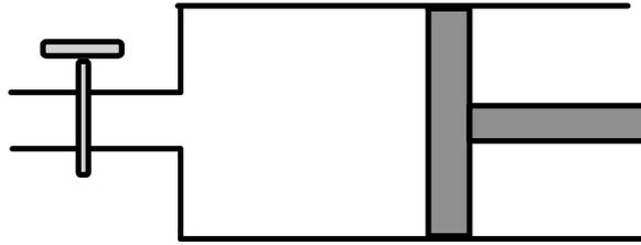
Após a admissão da porção de água, a torneira foi fechada. Variando-se o volume, por movimento lento do pistão, mantendo a temperatura, no interior do cilindro, igual a 20 °C, o gráfico de pressão no cilindro versus volume, corresponde a:
