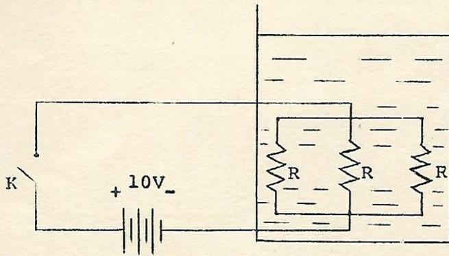
A figura representa um aquecedor elétrico composto de um recipiente suposto adiabático e de um circuito cujas três resistências  $R$  são iguais.
